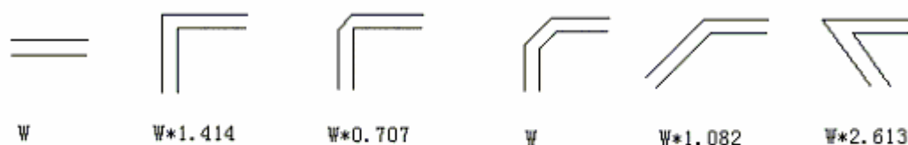
图1-8-13 不同角度走线的拐角线宽变化
